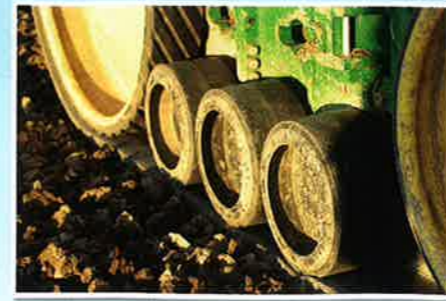
MARSHMALLOWS: Die 8RT-Serie hat drei kleine Druckwalzen.
