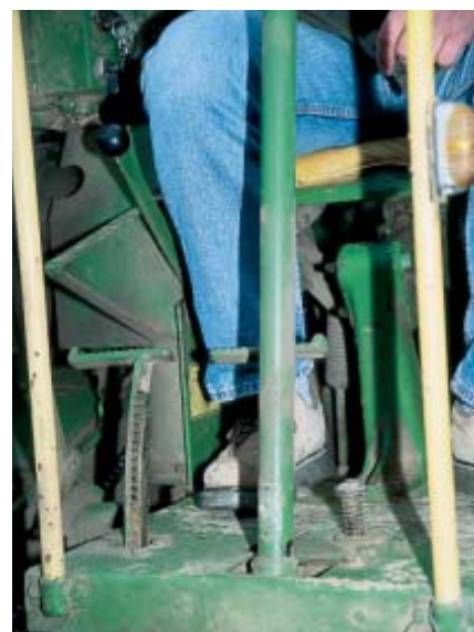
Das Fahrpedal mit einem Zahnprofil zum Arretieren. Je weiter es durchgetreten wird, um so schneller läuft der Variator. Zum Schalten wird es ganz losgelassen. Fotos: Eberwien, Holtmann (5)
