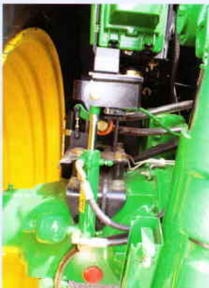
Die Leitungen der hydraulischen Kabinenfederung sind jetzt kreuzweise verbunden. Das reduziert die Seitenneigungen.
