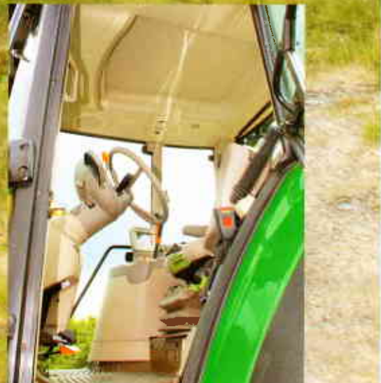
Durch die hellen Materialien wirkt der Innenraum luftiger, das Design ist modern. Mit nur 70,6 dB(A) soll eine sehr gute Lärmdämmung erreicht werden.
