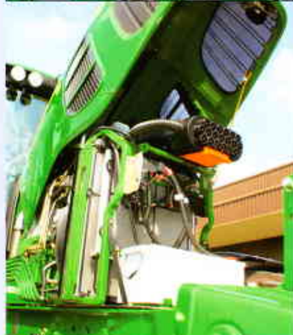
6,8 l-Sechszylinder: Der variable Turbolader mit den beweglichen Lamellen (1) soll für eine bessere Charakteristik sorgen.
