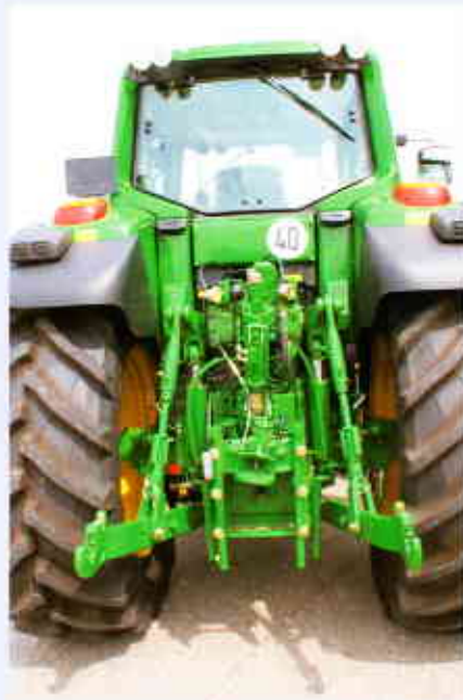
Auf Kritik reagiert: Dank neuem Hinterachsgehäuse sind höhere Hubkräfte bis 9000 daN und ein weiterer Hubweg drin.
