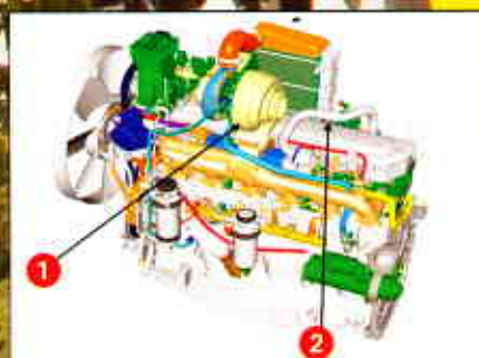
6,8 l-Sechszylinder: Der variable Turbolader (1) soll Spritzigkeit und Drehmoment steigern. Dazu kommt die externe Abgasrückführung (2).
